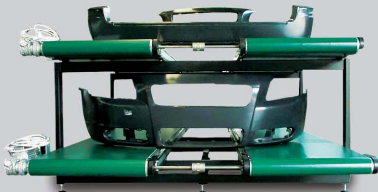
Modello LD Nastri trasportatori sovrapposti per paraurti
