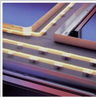
Modello L Nastri trasportatori intersecati per evitare ostacoli al prodotto
